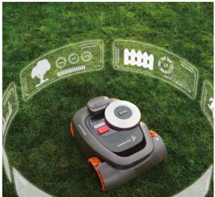
**DER VISIONFENCE SENSOR** ist mit einer KI ausgestattet, die es Ihrem Navimow ermöglicht, verschiedene Objekte zu erkennen und noch intelligenter zu mähen.
